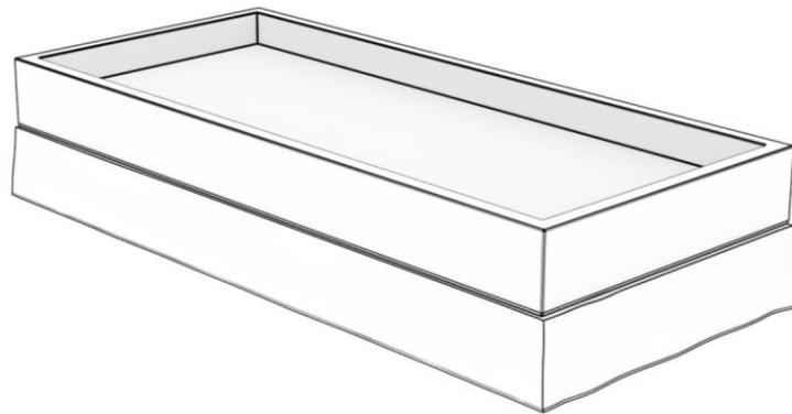
Abbildung 4: Installieren der Schutzfolie über den Schaumkern.
