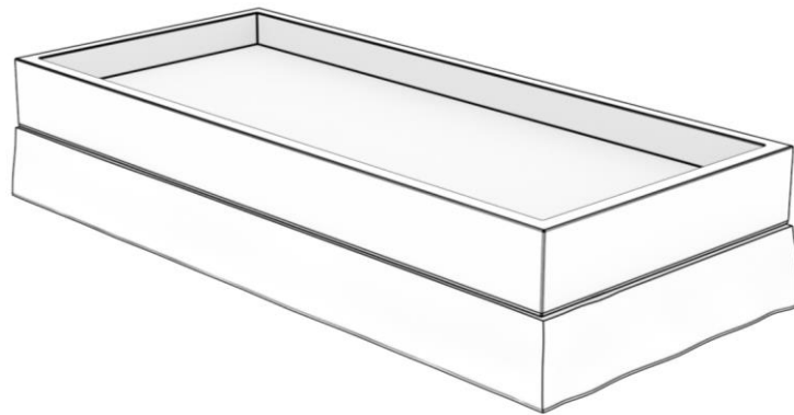
Abbildung 4: Installieren der Schutzfolie über den Schaumkern.
